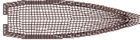
Şekil 7. 7.62 mm G-3 Çekirdeğinin Ağ Modeli (Mesh)
