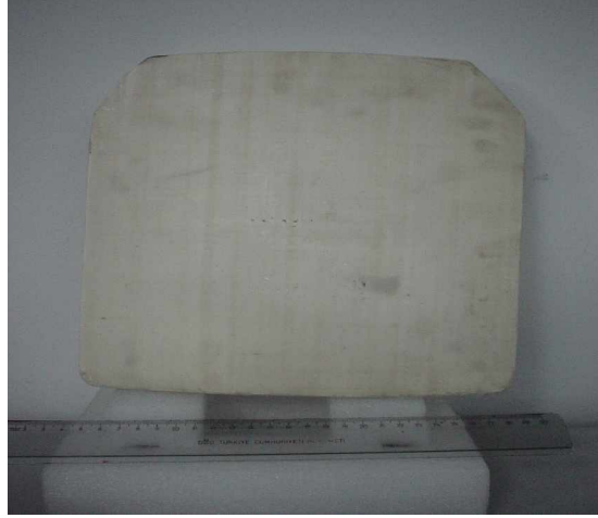
Şekil 3. Preslenerek Üretilen Zırh
