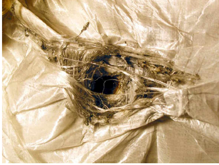
Şekil 11. Mermi Testi Sonrası Preslenmeden Üretilen Zırhın Görünümü
