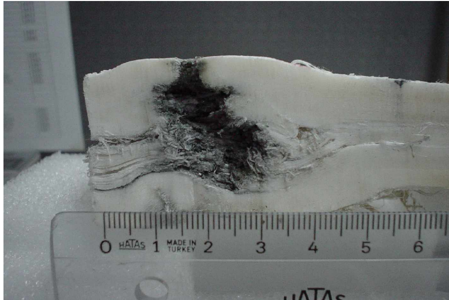
Şekil 9. Mermi Testi Sonrası Preslenerek Üretilen Zırh Kesitinin Görünümü
