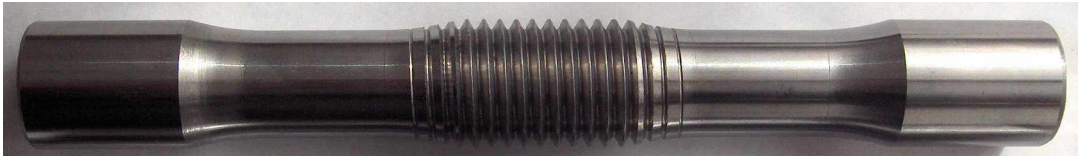
Şekil 3. Vidalı yorulma deney numunesi
