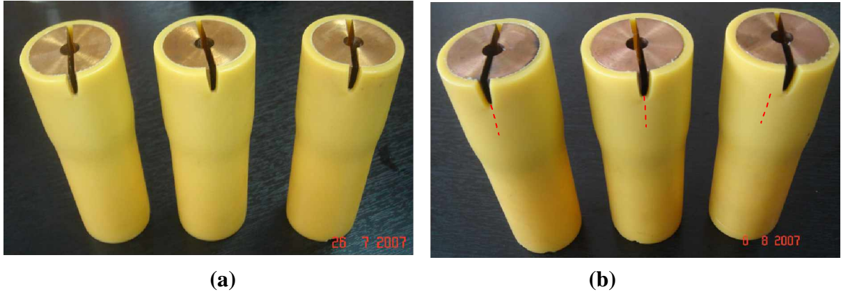
Şekil.8 Çentikli koni testi. a) Test başlangıç anı, b) Bir hafta sonra
