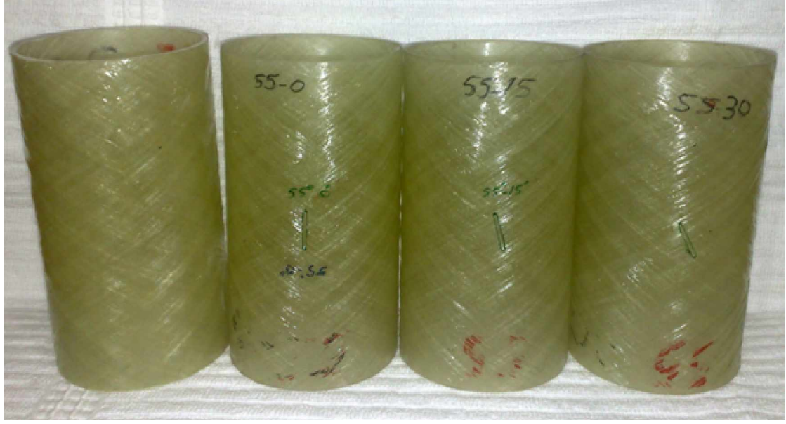
Şekil 5. Çentiksiz ve sırasıyla 0^\circ , 15^\circ ve 30^\circ açılarda çentik açılmış boruların deney sonrası resimleri
