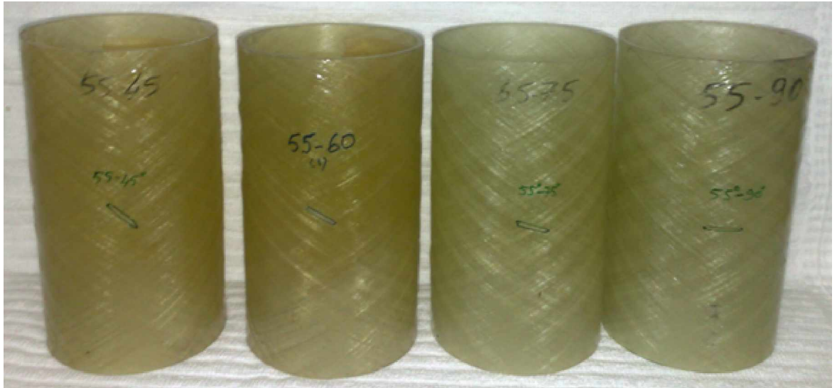
Şekil 6. Sırasıyla 45^\circ , 60^\circ , 75^\circ ve 90^\circ açılarda çentik açılmış boruların deney sonrası resimleri
