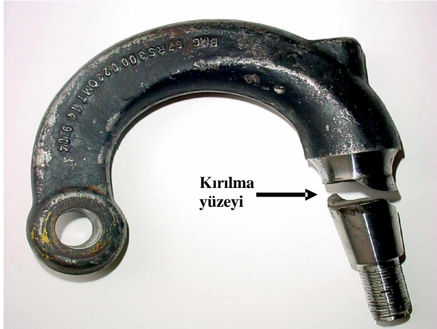
Şekil 2. Hasarlı çolak kolu.
