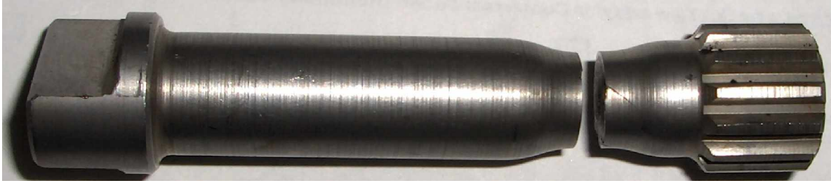
Şekil 4: Dizel motor pompa milinin kırılmış komple hali
