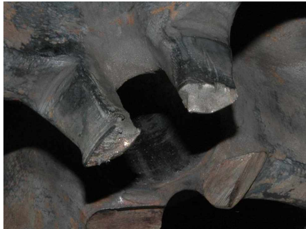
Şekil-2.5 Kırılan yüzey üstte kırılma setleşen cidarda gevrek özellik gösterirken orta kısımda sünek kırılma gözlenmektedir.
