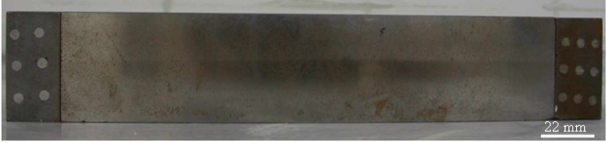
Şekil 1. Çelik tellerin yerleşim düzeni ve üç nokta eğme deney numunesi
